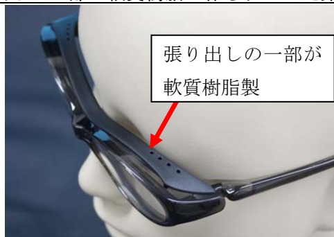
写真 6. 張り出しの一部が軟質樹脂で作られていた銘柄 (No. 8)
