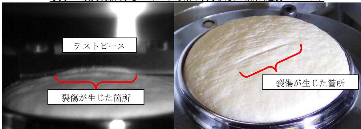
写真 10. 硬質樹脂 (厚さ 3mm) による落下衝撃試験の結果 (速度 1500mm/s)
