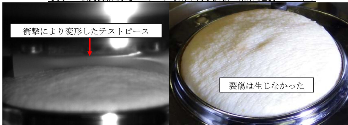
写真 11. 軟質樹脂(厚さ 3mm)による落下衝撃試験の結果(速度 1500mm/s)
