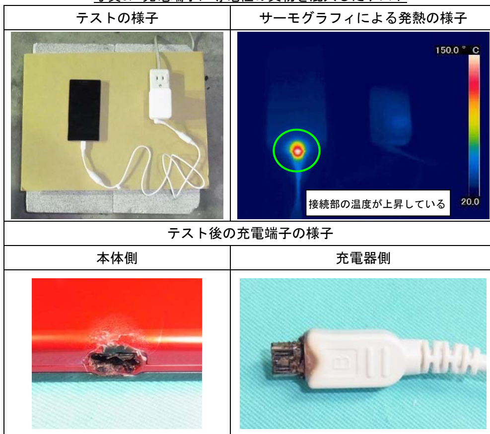
写真3. 充電端子に導電性の異物を混入したテスト
