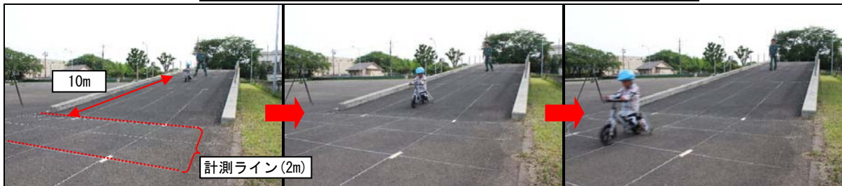
写真3. テスト風景の例(傾斜6° の坂を10m滑走した場合)
