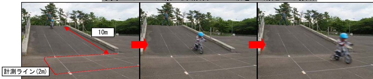
写真4. テスト風景の例(傾斜10° の坂を10m滑走した場合)
