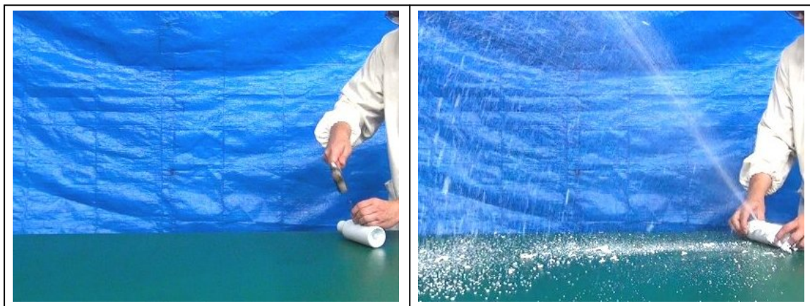
写真5. ムース（化粧品）をハンマーで釘打ちしたときの様子（左：穴開け中、右：穴開け直後）
