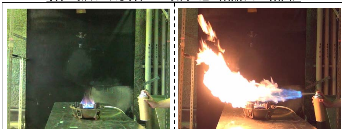
写真1. 引火して大きな炎が上がる様子（左：噴射前、右：噴射時）
