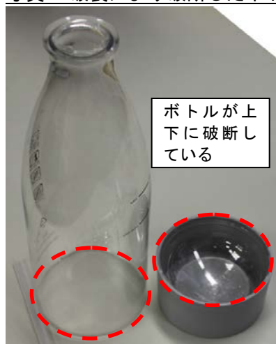
写真3. 破裂により破断したボトル (事例3)
