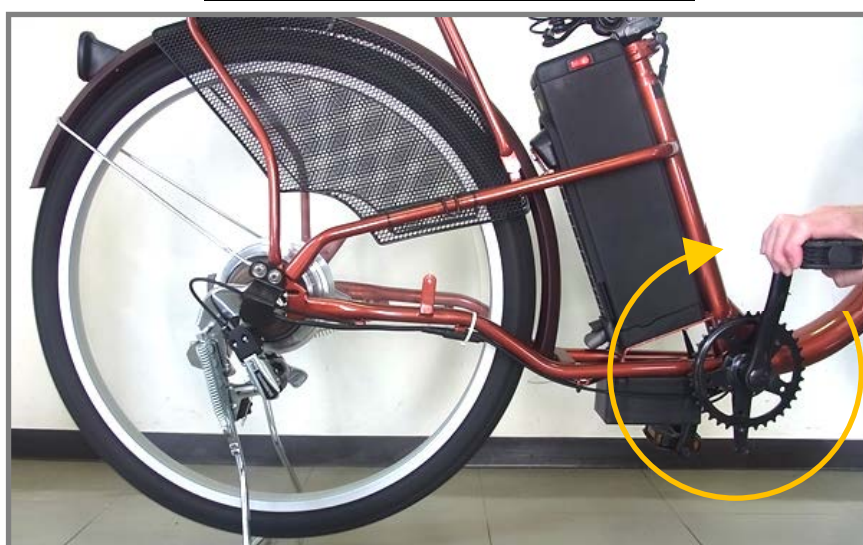
写真3. ペダル回転によるモーター駆動
