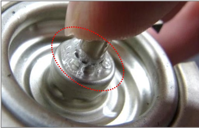
写真1. 内部パッキンの劣化によってガス漏れが発生したカセットボンベ
