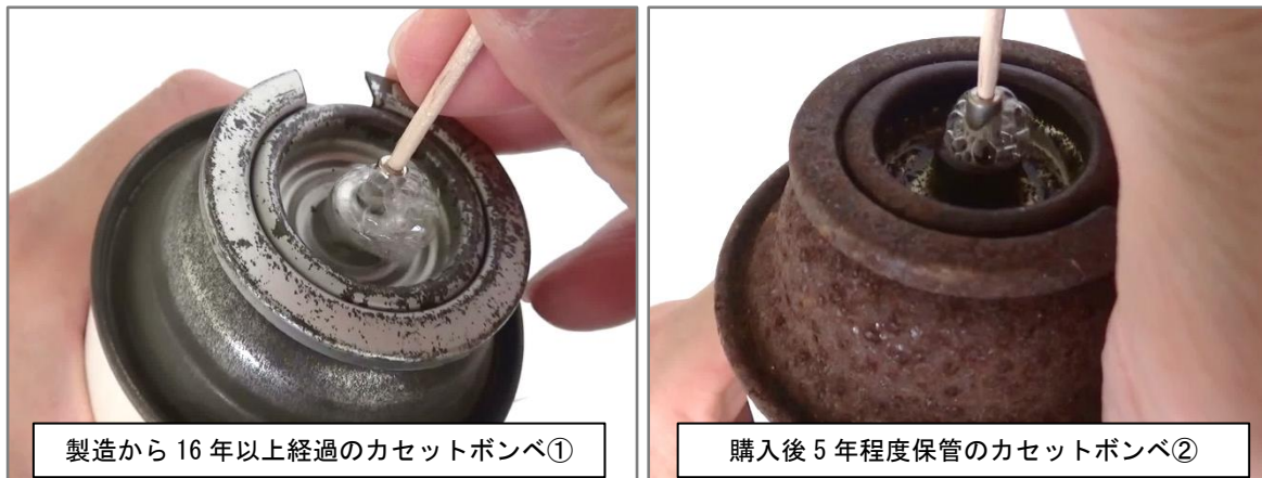
写真3. ガス漏れの調査
