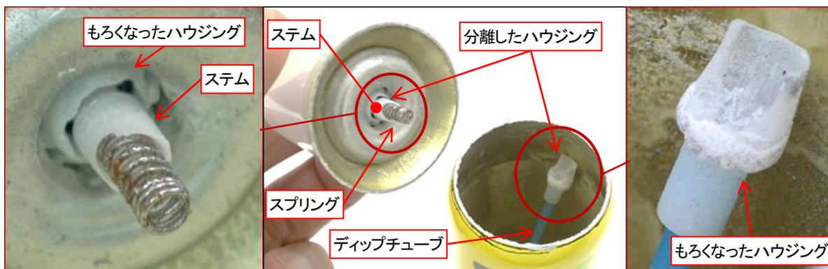
写真. もろくなって脱落したハウジング
