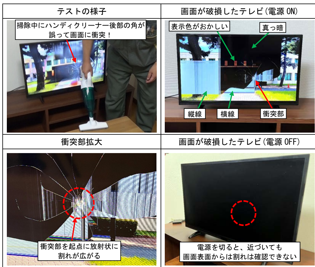
写真4. 液晶テレビの破損
