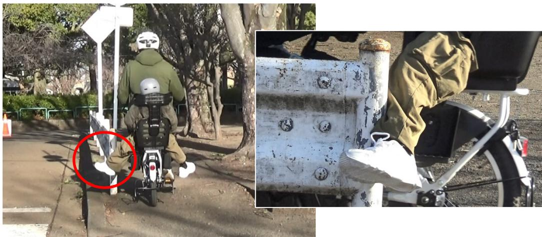
写真4. ダミー人形の足がガードレールと接触する様子
