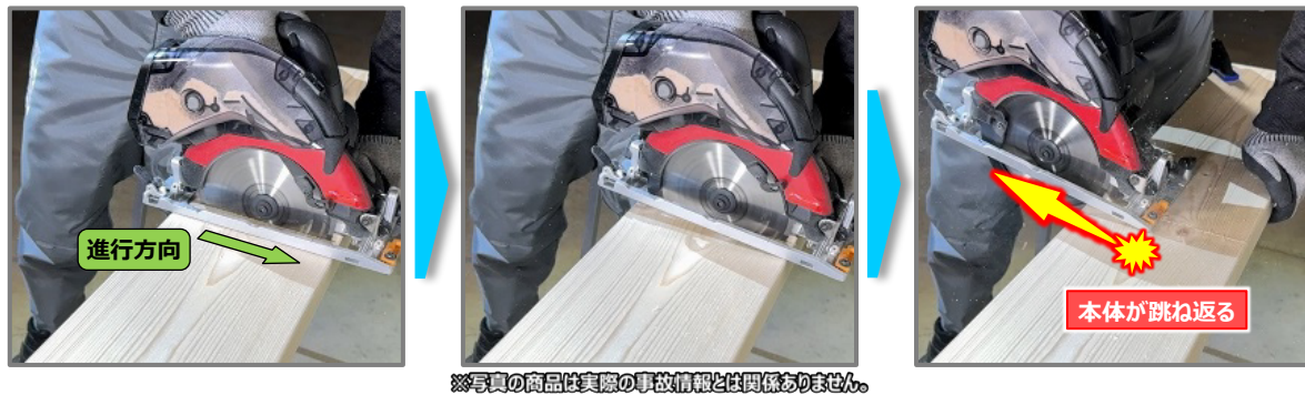
写真 16. 丸のこで発生したキックバックの様子(写真9再掲)
