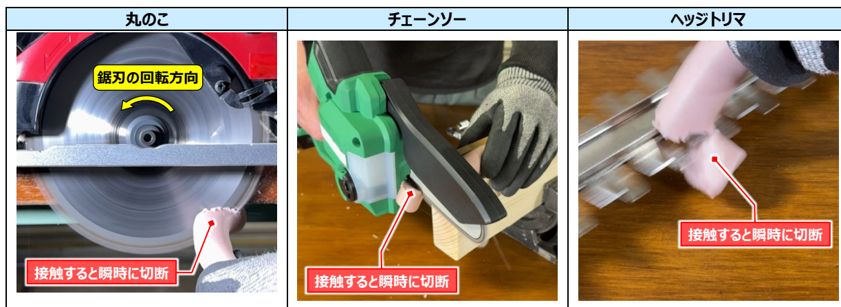
写真 14. 先端工具に指が接触してしまった事故の再現（指を模したソーセージを使用）
