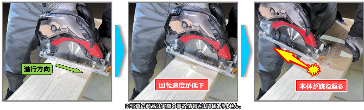
写真 9. 丸のこで発生したキックバックの様子
